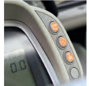
**+** Sehr praktische Helfer sind die – bei Shuttle-Ausstattung serienmäßige – Stop-and-go-Funktion und die optionale SDD-Lenkübersetzung. Beide werden rechts im Kombiinstrument aktiviert.
