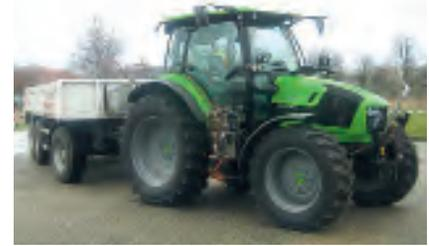
**Sparfuchs:** Während unser Testkandidat auf dem Zapfwellenprüfstand durchschnittliche bis gute Werte ablieferte, kann er im PowerMix fast durchgängig punkten.
