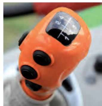
**+/-** Die Lastschaltstufen bieten Speed-Matching. Kupplern geht per Fußpedal oder Druckknopf. Das Einlegen der Gänge 2 und 3 ist nicht immer ganz einfach. Die Synchronisation könnte besser sein.
