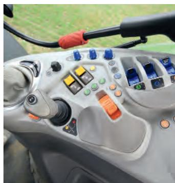
**+** An Steuergeräten sind bis zu vier mechanische oder fünf elektrohydraulische lieferbar (jeweils mit mechanischem oder elektrohydraulischem Kreuzschalthebel) und es gibt drei Pumpenvarianten.
