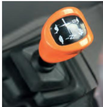
**+** Mit Superkriechgängen kommt das Getriebe auf 60 x 60 Gänge – typisch SDF. Los geht es bei rund 0,12 km/h, Schluss ist bei 50 km/h (bei leicht reduzierter Motordrehzahl von 2.100 U/min).
