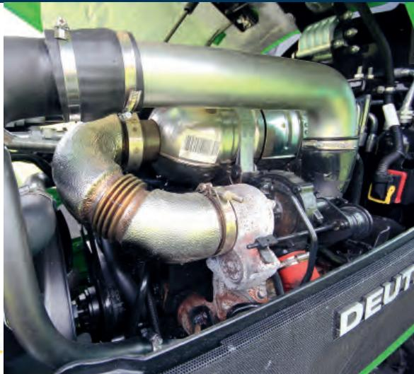
**Durchschnittlich:** Der Kölner Vierender zeigte auf dem Zapfwellenprüfstand gute, wenn auch keine Spitzen-Verbrauchswerte. 272 g/kWh bei Nenndrehzahl und 248 bis 255 g/kWh bei Maximalleistung liegen etwa im Durchschnitt dieser Leistungsklasse, wobei der 5120 P anders als einige Wettbewerber kein AdBlue für die Abgasreinigung benötigt. Aussagekräftiger für den Praxiseinsatz sind jedoch die PowerMix-Verbrauchswerte, die Sie auf der gegenüberliegenden Seite finden.
