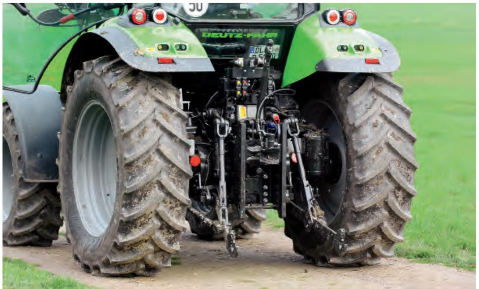
**Hubstark:** Mit den zwei äußeren Zusatzzylindern sind bis zu 6,6 t maximale Hubkraft möglich (Herstellerangabe). Das ist für diese Klasse top!
