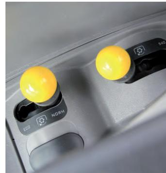
**+** Optional sind vier Zapfwellengeschwindigkeiten „on board“. Die Vorwahl erfolgt links vom Fahrersitz, die Zuschaltung und das Abschalten elektrohydraulisch per Wippe oder per Automatik.
