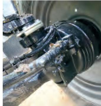
**+** Serienmäßig kommt der 5er mit vier Scheibenbremsen daher. Dazu schaltet beim Bremsen der Allradantrieb zu. Damit sind extrem gute Verzögerungswerte bei geringer Pedalkraft möglich.
